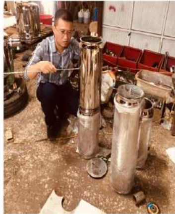
Chủ nhiệm TS. Dương Thành Nam đang gia công, lắp đặt tháp trộn bụi của ManDust
