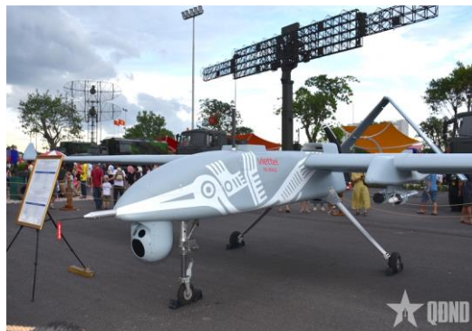
UAV có chiều dài 8,5 m, chiều dài sải cánh 17 m.
